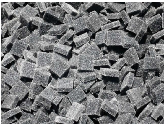
LEVAPOR поставляется в виде прямоугольных гранул (размер 20 x 20 x 7 мм)
